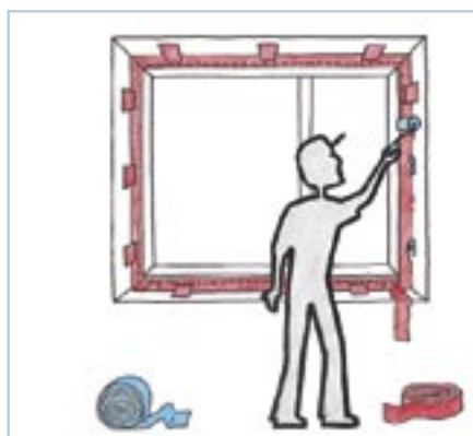
4. TROJROVINOVÁ MONTÁŽ S PÁSKAMI: nalepenie vonkajšej a vnútornej tesniacej pásky
